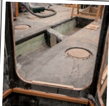
Structural tanks - Serbatoi strutturali For more rigidity and better use of space, the tanks are structural Per una maggiore rigidità e un miglior sfruttamento dei volumi, i serbatoi sono strutturali
