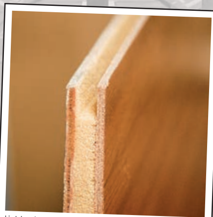
Lightweight wooden - Legno alleggerito Many elements of furniture are made with sandwich lightwood Molti componenti di arredo sono realizzati con legni alleggeriti
