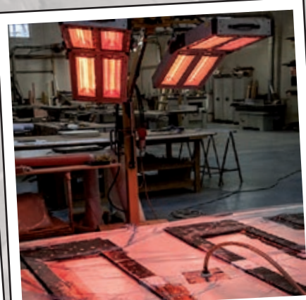
Postcure - Postcura Many composite elements are post cured with heat treatment Molti elementi in composito vengono curati con trattamento termico
